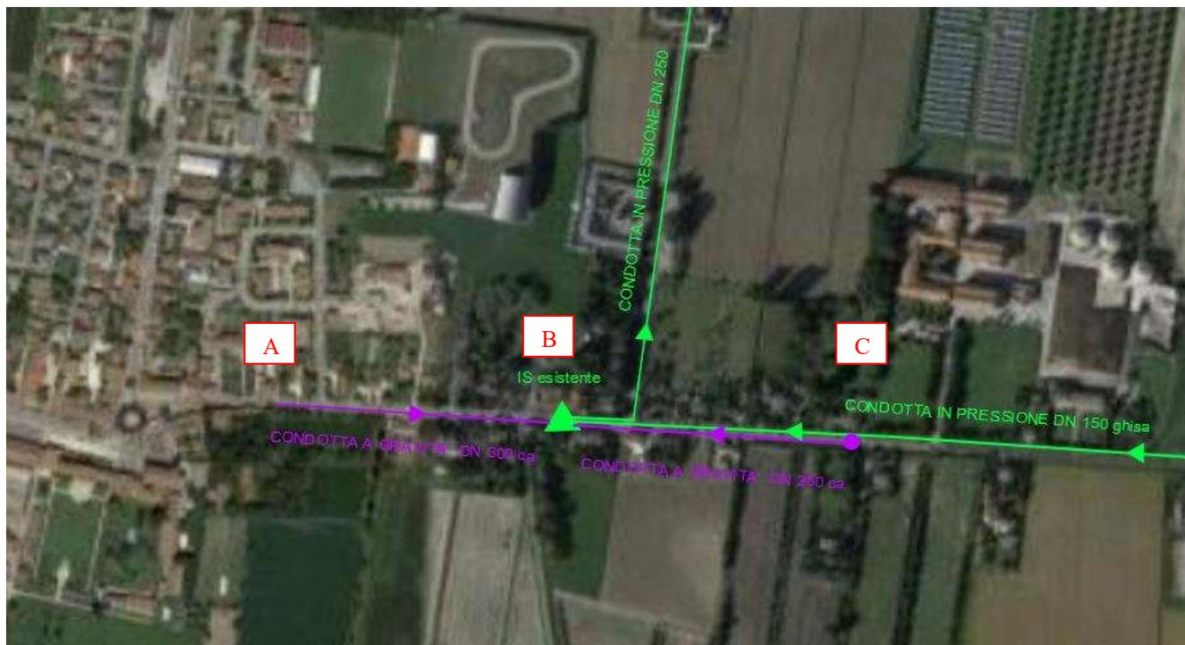
La condotta fognaria esistente raccoglie le utenze di circa 42 abitazioni, per poi rilanciarle, tramite il sollevamento posto a ridosso di via Pastò (punto B), mediante la condotta in pressione verso nord, lungo via Martiri di Cefalonia. Le tubazioni a gravità in via Garibaldi risultano collocate ad una profondità di circa 3,00 m rispetto al sedime stradale e ad oggi si presentano in pessimo stato di conservazioni e oggetto di numerosi interventi di riparazione.
